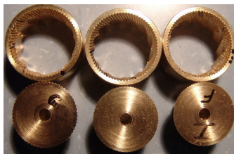
Testmuster aus Messing mit unterschiedlicher Zahnteilung
