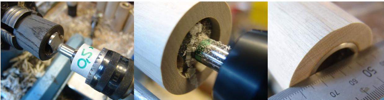
Um den Gewindering im Mühlenkörper einzusetzen, muss oben die Bohrung 11 mm tief auf 31 mm erweitert werden (mit Kegelsenker, oder dns-MAK). Danach sollte er genau plan abschließen. Deshalb ist beim Verkleben darauf zu achten, dass die plane Seite des Rings nach oben zeigt.
