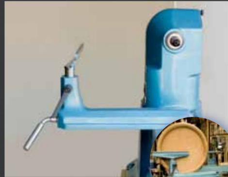
Extra langes, knapp 10 kg schweres Handauflagenunterteil aus Grauguss für große Querholzdurchmesser (460 mm lang, 150 mm hoch)
