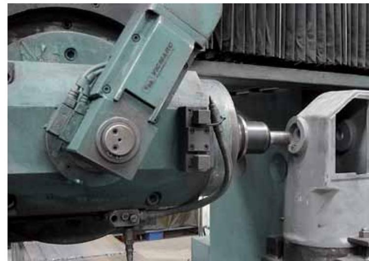
Einfräsen der Lagersitze für die Schalen der Kegelrollenlager
