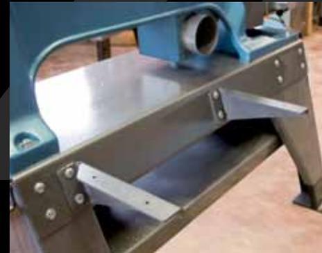
Absaugkasten mit 100-mm-Anschluss wird zwischen den Bettflanken eingehängt. 3 Befestigungspunkte zur Anbringung von Montagewinkeln für individuelle Ablagen hinter der Maschine
