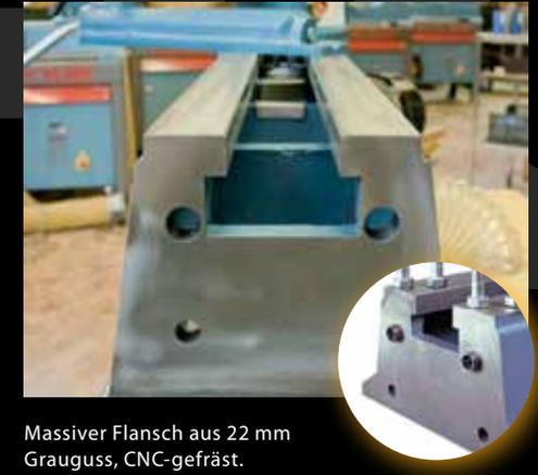
Massiver Flansch aus 22 mm Grauguss, CNC-gefräst. Mit zwei geschliffenen Führungshülsen zur sicheren und präzisen Aufnahme der Bettverlängerung
