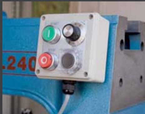
Die Drehzahlregelung befindet sich in einem stabilen Stahlblechgehäuse, das flexibel montierbar ist. Die Steuerung erfolgt über eine Magnetschalterbox.
