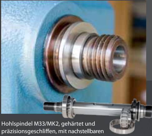
Hohlspindel M33/MK2, gehärtet und präzisionsgeschliffen, mit nachstellbaren Kegelrollenlagern und Ablaufsicherungsnut. Spindelnase M33 beidseitig, ermöglicht das Aufbringen von z.B. Schleif- und Polierscheiben.
