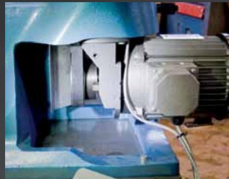
Eine geniale Konstruktion aus dem Hause VICMARC! Tiefe, statisch und „staubtechnisch“ günstige Motoraufhängung unterhalb des Bankbettes in stabiler Gusskonstruktion.
