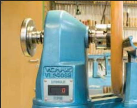
Ergonomisch geformter Spindelstock. Die Digital-Anzeige zeigt die aktuelle Spindeldrehzahl unabhängig von der Riemenstellung.
