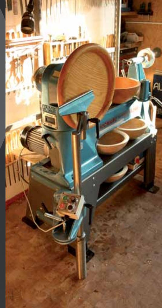
Für „Großprojekte“ bis Ø 1200 mm besitzt die VL 240 Montagepunkte für die Außendrehvorrichtung (Zubehör). Die bewährte, höhenverstellbare VICMARC-Konstruktion ist steif und vibrationsarm, sie leitet entstehende Kräfte direkt in den Boden ab.
