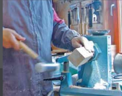
Rundlaufkorrektur beim „Fliegendrehen“ durch außermittiges Schlagen auf die Stirnseite, dank Kegelrollenlagern kein Problem.
