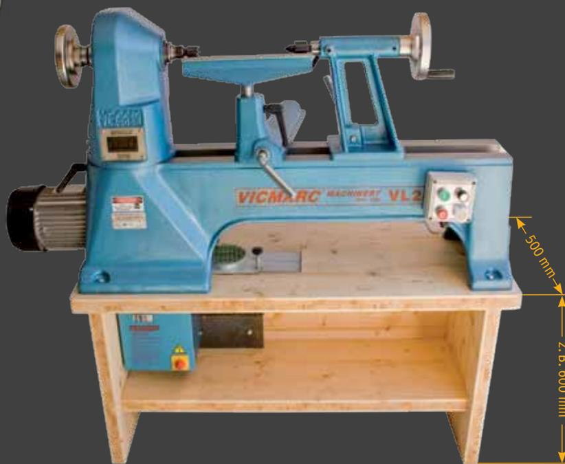
**Eigenbau:** Untergestell aus 40 mm starker 3-Schicht-Platte mit integrierter Absaugung und 50-kg-Metallbeschwerung
