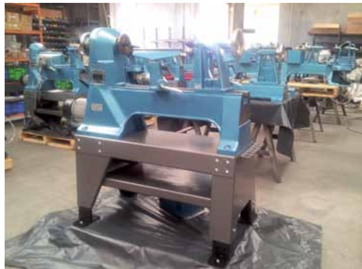
Spindelstock und Reitstock sind nummeriert und präzise zueinander eingeschliffen. So fluchten die Spitzen nach der Montage garantiert! Konzentration und Sorgfalt beim Verkabeln der Elektronik.
