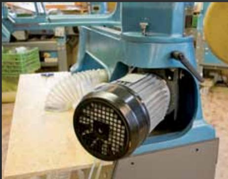
Mit dem Klemmhebel kann der Spindelkopf in jeder beliebigen Position sicher fixiert werden.
