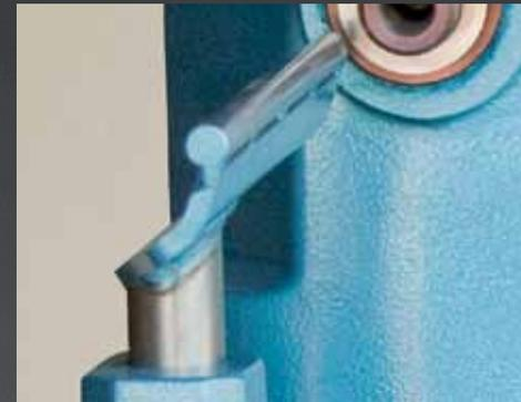
Neue Handauflage mit aufgesetztem Rundstahl und 30 mm starkem Schaft, äußerst schwingungsarm!
