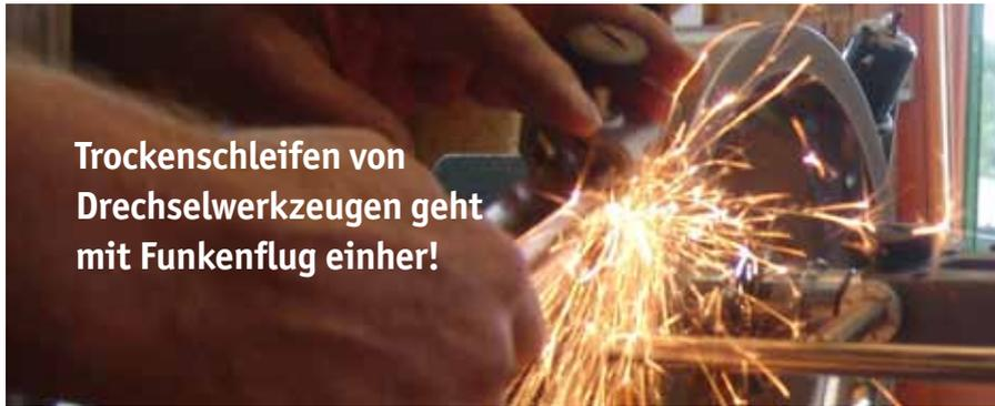
Trockenschleifen von Drechselwerkzeugen geht mit Funkenflug einher!
