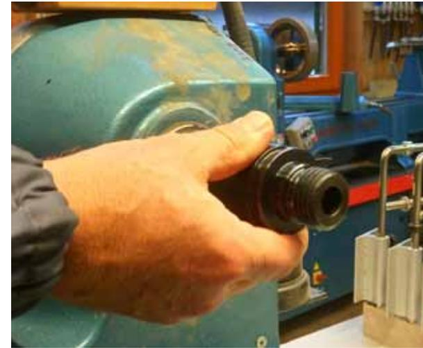
Montieren Sie die CBN-Scheibe mit der Aufnahme für den 41 mm Gabelschlüssel in Richtung Reitstock.
