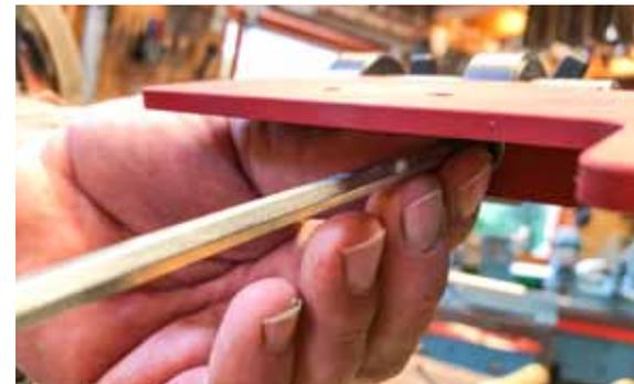
Abschließend die beiden Innensechskantschrauben der Halteringe fixieren.
