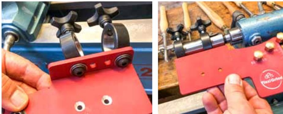
Vormontierte Halte-Ringe über die dns-FlexiGrind-Reitstockaufnahme schieben und positionieren. Die beiden Sternschrauben entsprechend anziehen.
