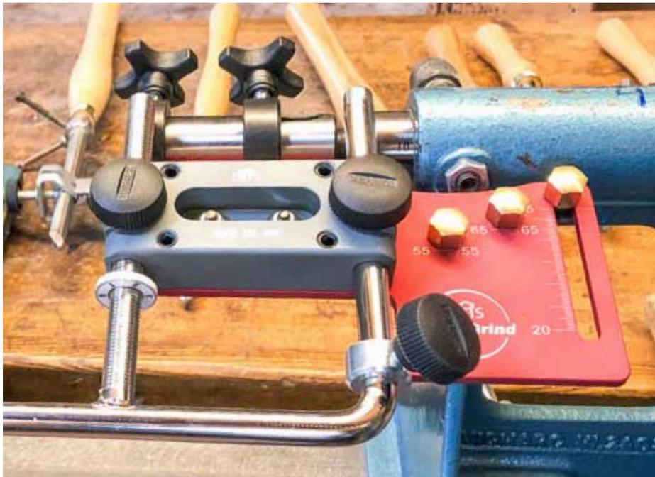
Rändelschraube und Stellingring auf den Tormekbügel aufschrauben und den Haltebügel im Bügelhalter einsetzen.
