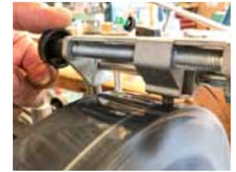
Vor dem Schärfvorgang den Stein entsprechend abrichten, so dass dieser 100% plan ist. Zur Sicherheit mit einem Anschlagwinkel nachprüfen
