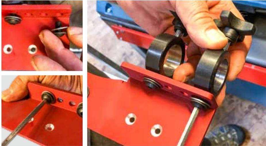
Die beiden Innensechskantschrauben mit Unterlegscheiben, wie gezeigt, mittels eines 5 mm Innensechskantschlüssels in den dafür vorgesehenen Löchern anbringen und die beiden Halte-Ringe locker vormontieren.
