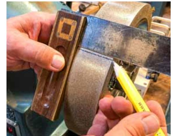
Die beiden M8 Muttern (Pos. X) erneut leicht lösen und den Bügel rechtwinklig zur Scheibe positionieren, die Schrauben leicht anziehen und mit dem Bügel bis dicht vor die Scheibe fahren.
