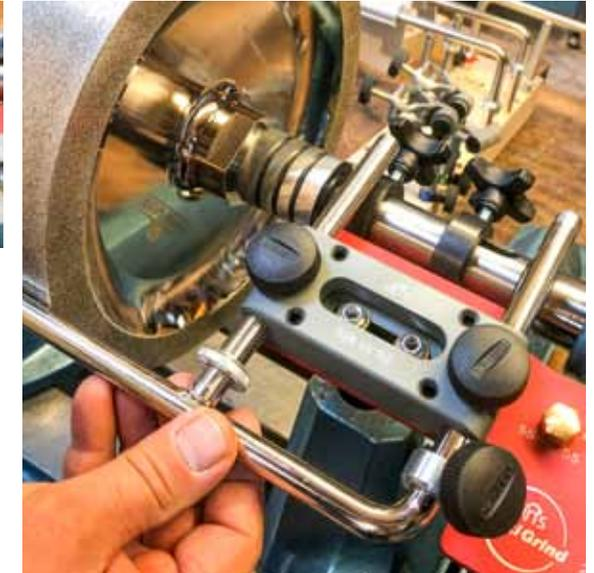
Zeichnen Sie mit einem Anschlagwinkel eine 90° Linie mit dem Bleistift über die CBN-Scheibe. Jetzt über den Bügel peilen und schauen ob Bügel und Bleistiftstrich parallel verlaufen.
