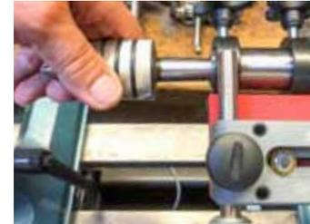
Den Rollkörper einstecken und mit dem Reitstock an die montierte CBN-Scheibe heranfahren. Reitstock fixieren.
