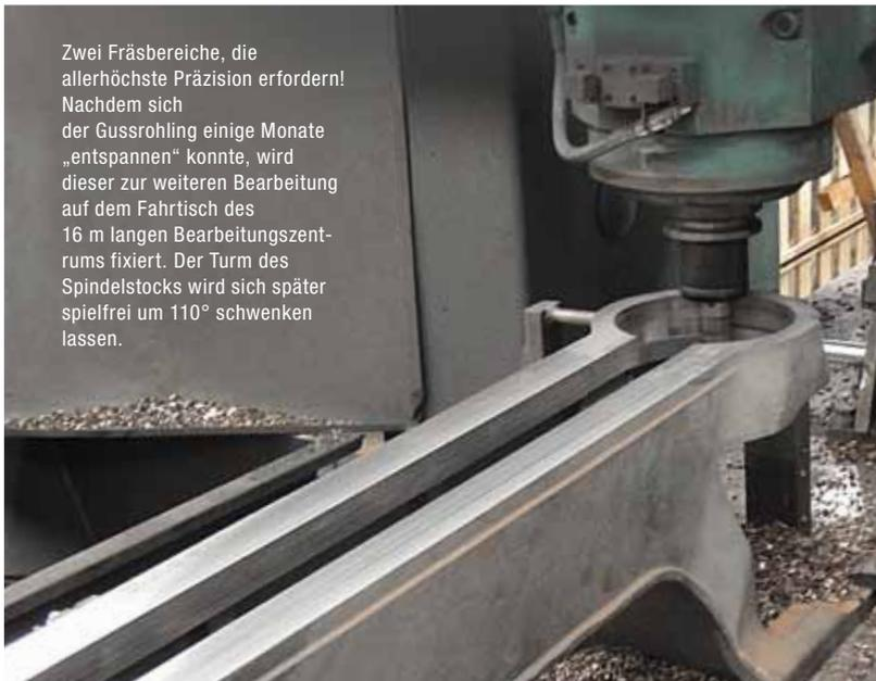
Zwei Fräsbereiche, die allerhöchste Präzision erfordern! Nachdem sich der Gussrohling einige Monate „entspannen“ konnte, wird dieser zur weiteren Bearbeitung auf dem Fahrtisch des 16 m langen Bearbeitungszentrums fixiert. Der Turm des Spindelstocks wird sich später spielfrei um 110° schwenken lassen.
