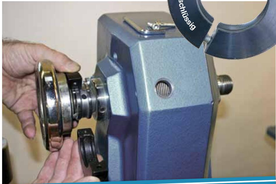
Die CE-Sicherheits-Normen schreiben vor, dass Drehmaschinen mit Rechts- und Linkslauf mit einem Ablaufsicherungsring ausgestattet sein müssen.
