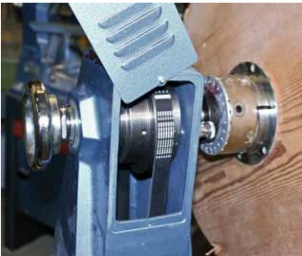
Riemen auf größte Spindelriemenscheibe legen = minimale Geschwindigkeit (bis 1000 U/min.) und maximales Drehmoment und beste Motorkühlung
