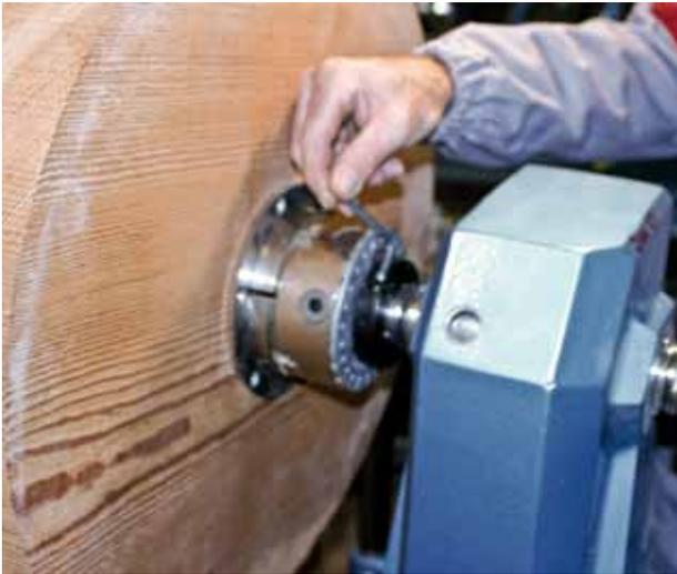
Befestigen des Ablaufsicherungsring
