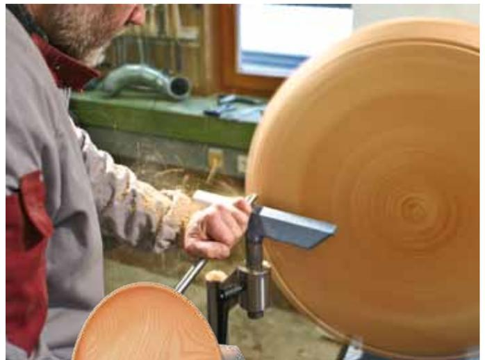
**ACHTUNG:** Bei VL 200 und VL 300 darf mit außen montiertem Spannfutter nur im Linkslauf des Motors gearbeitet werden.
