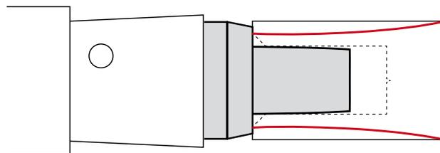
Ca. 2 mm unterhalb der Schräge Kleber angeben und die Edelhülse, ohne Deckel, bis zum „45° Anschlag“ mit behutsamer Drehbewegung einschieben.
