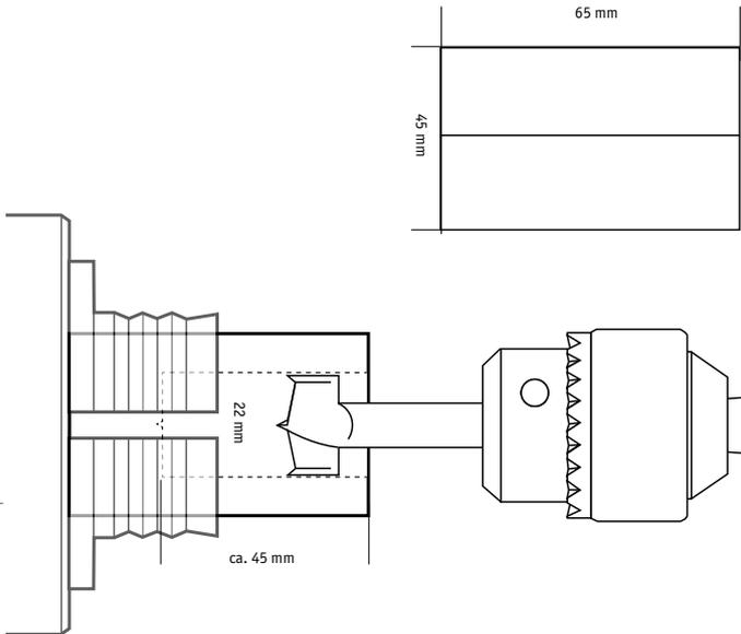
Passenden Rohling (rund oder eckig z.B. 65 x 45 x 45 mm) im Vierbackenfutter einspannen und  $\varnothing$  22 mm ca. 35 mm tief einbohren.
