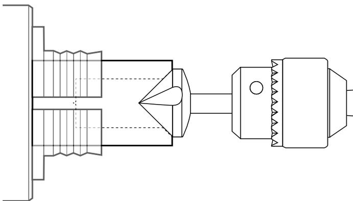
Bohrung von Hand, oder besser mit 31 mm Kegelsenker 45° anschrägen und je nach gewünschter Ausführung (siehe Skizze) entsprechend tiefer einsenken.
